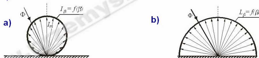
Rys. 1. Kształty krzywych rozpraszania powierzchni dyfuzyjnej: a) rozkład światłości, b) rozkład luminancji
